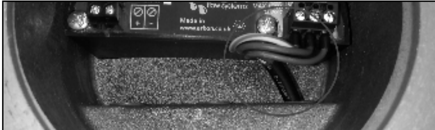
Imagen 1: Cable cruzado de corte redondo correctamente conectado dentro de la carcasa IP68 del MAGX2
